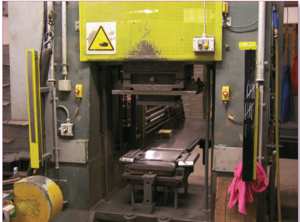
Bild 2: Die von beiden Seiten bedienbare Kurbelpresse bearbeitet die frisch von der Strangpresse kommenden Formteile. Ein Sicherheits-Lichtvorhang Focus und zwei Not-Halt-Taster Smile schützen vor Verletzungen.
