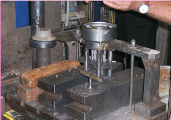
Bild 3: An der Hydraulikpresse arbeiten 2 Maschinenbediener gleichzeitig und pressen aus einer speziellen Masse Rohlinge für besonders massgenaue Keramik-Formteile.
