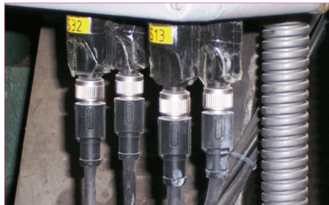
Bild 6: Das Anpassungsgerät Tina 3A ermöglicht den Anschluss von Unfallschutzgeräten mit mechanischen Ausgangskontakten an eine dynamische Sicherheitsschaltung nach Kategorie 4.
