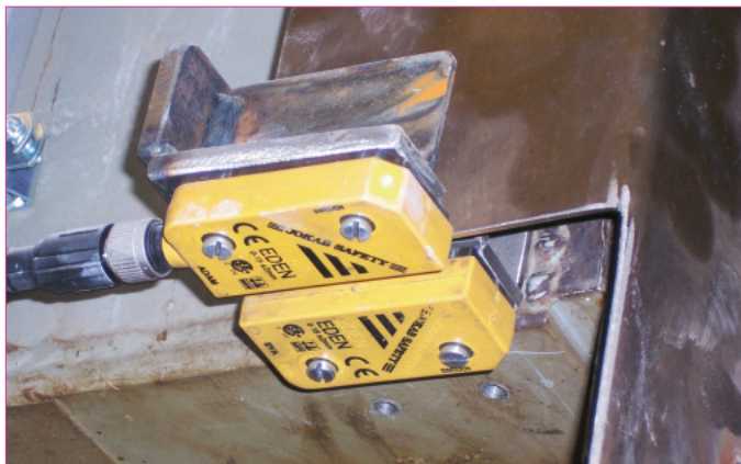
Bild 5: Die elektronischen Sicherheitssensoren Eden haben einen Schaltabstand von 0...15 mm. Dank ihrer grossen Toleranz für Ausrichtung und Versatz ist ihre Montage völlig unkritisch.
