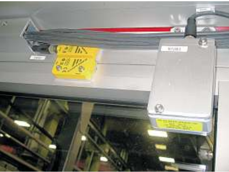
Der Elektromagnet erzeugt, ebenso wie sein kompakter Nachfolger Magne, eine Tür-Zuhaltekraft von bis zu 1500 N
