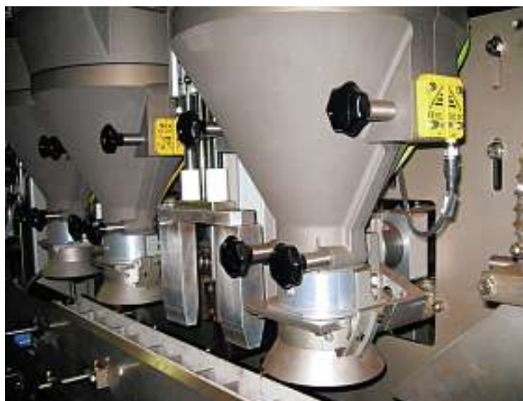
Sämtliche Rührbirnen der Schnecken dosierer werden mit berührungslosen, verschleissfreien Sicherheits-sensoren Eden überwacht (Foto Bosch)
