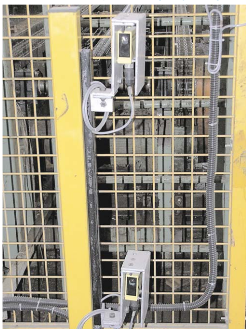
Bild 4: Zutrittsüberwachung mit einstrahliger Unfallschutz-Lichtschranke Spot in Einweg-Ausführung.
