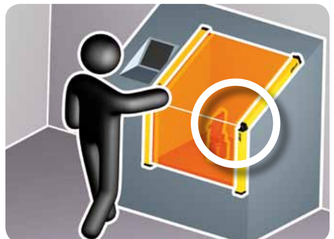
Die Auflösung wird an der „Nahtstelle“ zwischen den beiden kontrollierten Bereichen beibehalten (bis zu 40 mm)
