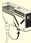
Laser-Ausrichthilfe JSRL2 für Lichtschranke Spot 35 T/R.
