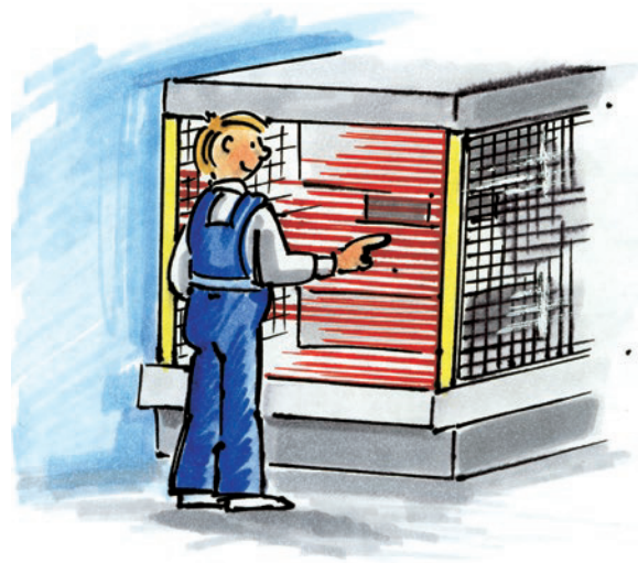
Sensordetektionsvermögen zur Fingererkennung
