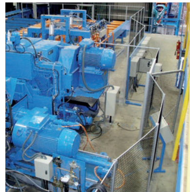
Quick-Guard® Express mit wenig Komponenten und einfach bis zu 45° abzuwinkeln.
