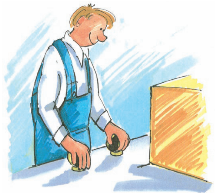
Alles zweikanalig bis zur Hand Safeball™ ist ein ergonomischer Zweihand-Befehlsgeber mit vier eingebauten Drucktastern.
