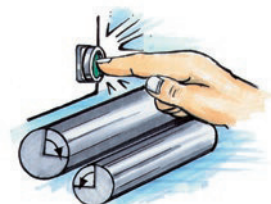
Die Welle dreht sich bei jeder Betätigung des Tasters nur um wenige Zentimeter weiter.
