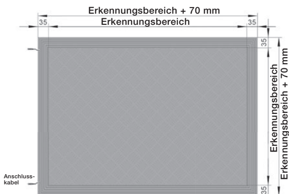
ASK 14-1T4.4-NP - Komplette Sicherheits-Schaltmatte mit angegossene Rampenschiene.
