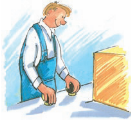
Ein Zweihand-Befehlsgeber, der komfortabel und leicht zu bedienen ist.
