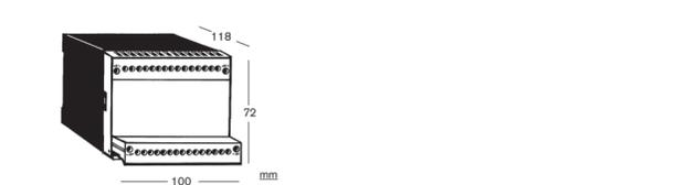
Les borniers sont débranchables (les conducteurs n'ont pas besoin d'être déconnectés)
