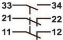
Anschlussblock - Konfiguration 2 Öffner, 1 Schließer
