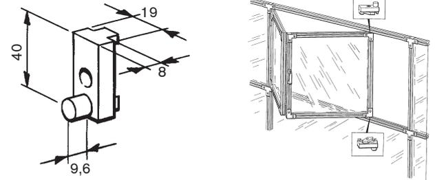
**Führungs-Bauteile für Schiebetür**
