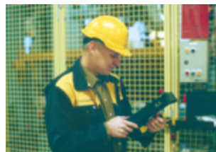
Zustimmungsschalter, angeschlossen an eine Maschinensteuerung.
