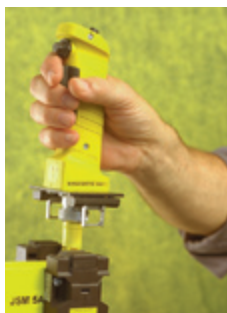
Zustimmungsschalter, angeschlossen an eine Maschinensteuerung.
