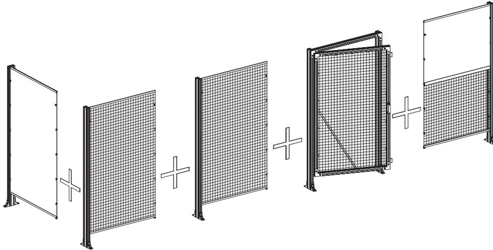
Die Express Abschnitte lassen sich mühelos zusammenbauen. Es ist auch möglich, diese Abschnitte im Winkel (45°) aufzustellen. Das Wellengitter lässt sich mit einem einfachen Schneidwerkzeug mühelos auf die gewünschten Maße schneiden.
