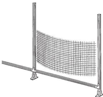
Zaunfüllung einsetzen und mittleres Profil montieren. Der Abstand zwischen den Profilen entspricht der Breite der Sektion minus 20 mm.
