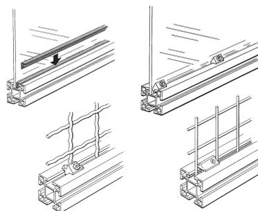
Zaunfüllung mit Spannleiste oder Gitterfixierungen sichern. Leicht, schnell und flink. Siehe unter Gitterfixierung. Besteht die Gefahr, dass der Roboter an das Polycarbonat stößt, ist die Plattenverriegelung JSM PL3 zu verwenden.
