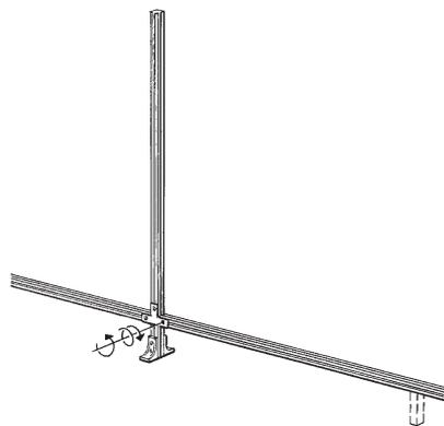
Unteres Profil an den Pfosten anschrauben. Ein Distanzstück gewährleistet den richtigen Abstand vom Boden.
