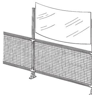
Obere Sektionen montieren. Oberes Profil mit Beschlägen beidseitig befestigen
