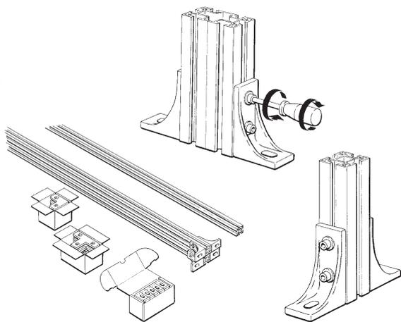
Zum Vormontieren der Bodenbeschläge erst die Schraube gegen den Uhrzeigersinn lösen. Dann wie üblich im Uhrzeigersinn anziehen. Die Mutter kommt so automatisch in die richtige Position und sichert den Beschlag im Zaunprofil.
