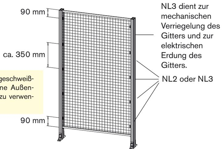
**Hinweis!** Bei geschweißtem Gitter ohne Außendraht ist NL3 zu verwenden!
