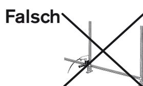
Montieren Sie vorübergehend mindestens zwei mittlere Profile, bevor Sie bohren und Pfosten am Boden befestigen. Diese Methode wendet man an, wenn Gitter oder Platten zu einem späteren Zeitpunkt eingebaut werden sollen.
