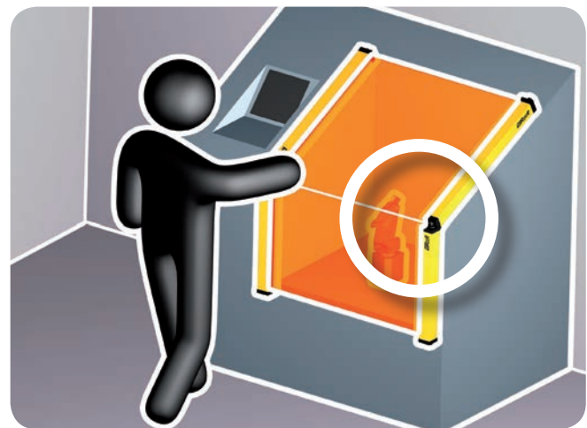
Die Auflösung wird an der Verbindungsstelle zwischen den beiden kontrollierten Bereichen beibehalten (bis zu 40 mm)
