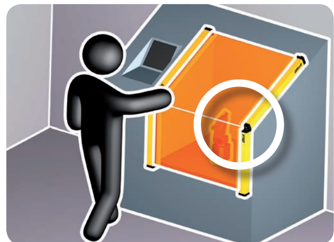
Die Auflösung wird an der „Nahtstelle“ zwischen den beiden kontrollierten Bereichen beibehalten (bis zu 40 mm)
